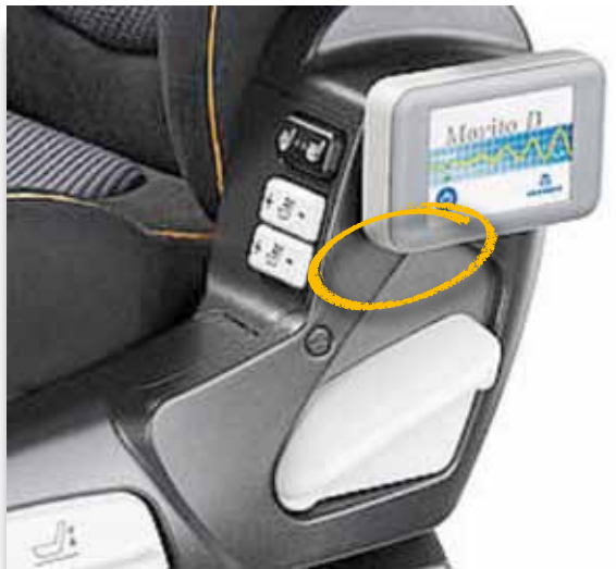
Ilustración 14 Medidor de vibraciones
