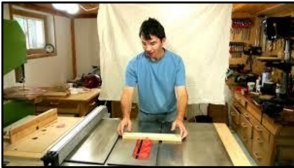
Recreación del trabajo en Sierra Circular sin Resguardos
