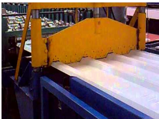
Guillotina usada para corte de láminas
