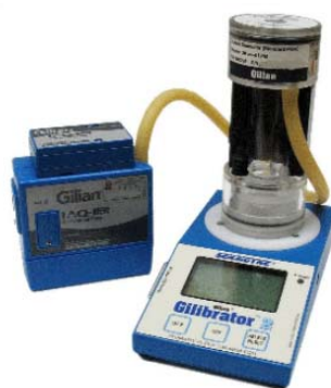
Fig. 8: Calibrador estándar para bombas de muestreo para agentes químicos
