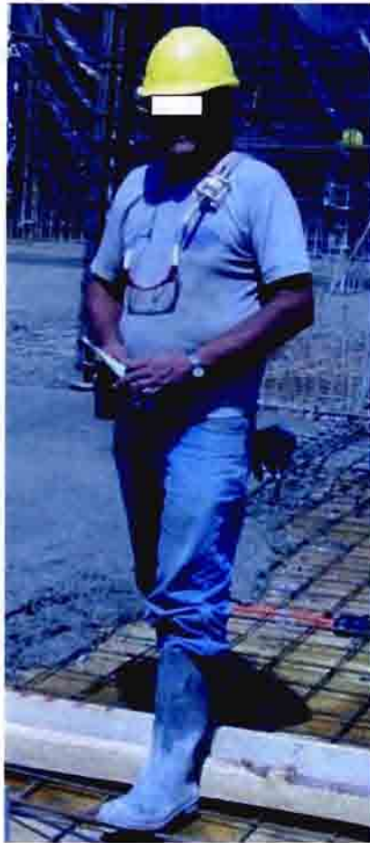
Figura N°6 . Muestreadores personales se instalaron en los trabajadores de acuerdo a puesto de trabajo.
