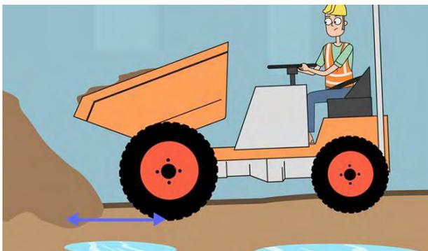
*No respetar una distancia de seguridad en función de la estabilidad del terreno.*
