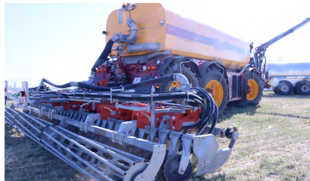
Figura 2. Esparcidora de purín autopropulsada con sistema de localización en profundidad.
