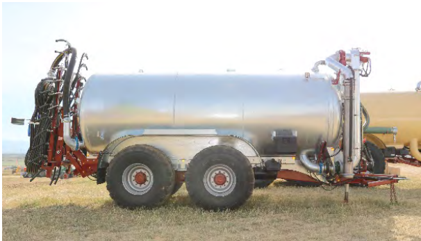
Figura 3. Cisterna de acero galvanizado.
