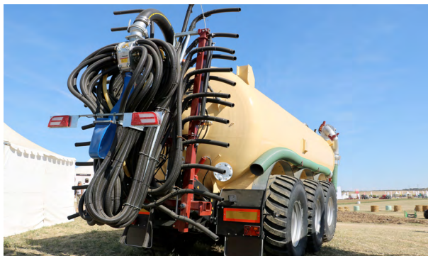
Figura 1. Esparcidora de purín de tres ejes con sistema de localización en superficie (aplicador de tubos colgantes).
