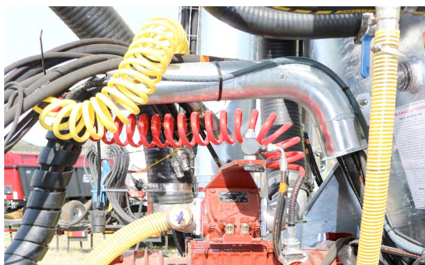
Figura 6. Válvula de seguridad y conexiones hidráulicas y neumáticas.
