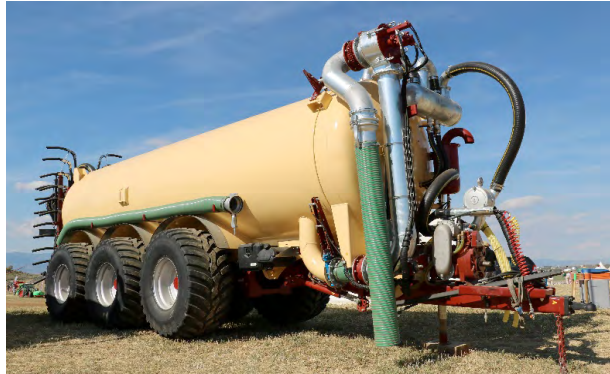
Figura 5. Brazo de llenado y manguera de aspiración.
