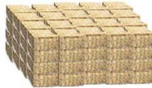
Apilamiento vertical bien equilibrado pero no trabado. Riesgo bajo si se asegura el desapilado con maquinaria adecuada y se establece un control periódico de la estabilidad.
