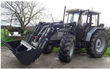
Foto 26 Tipo de apero (cazo) totalmente inadecuado para recoger fardos de paja
