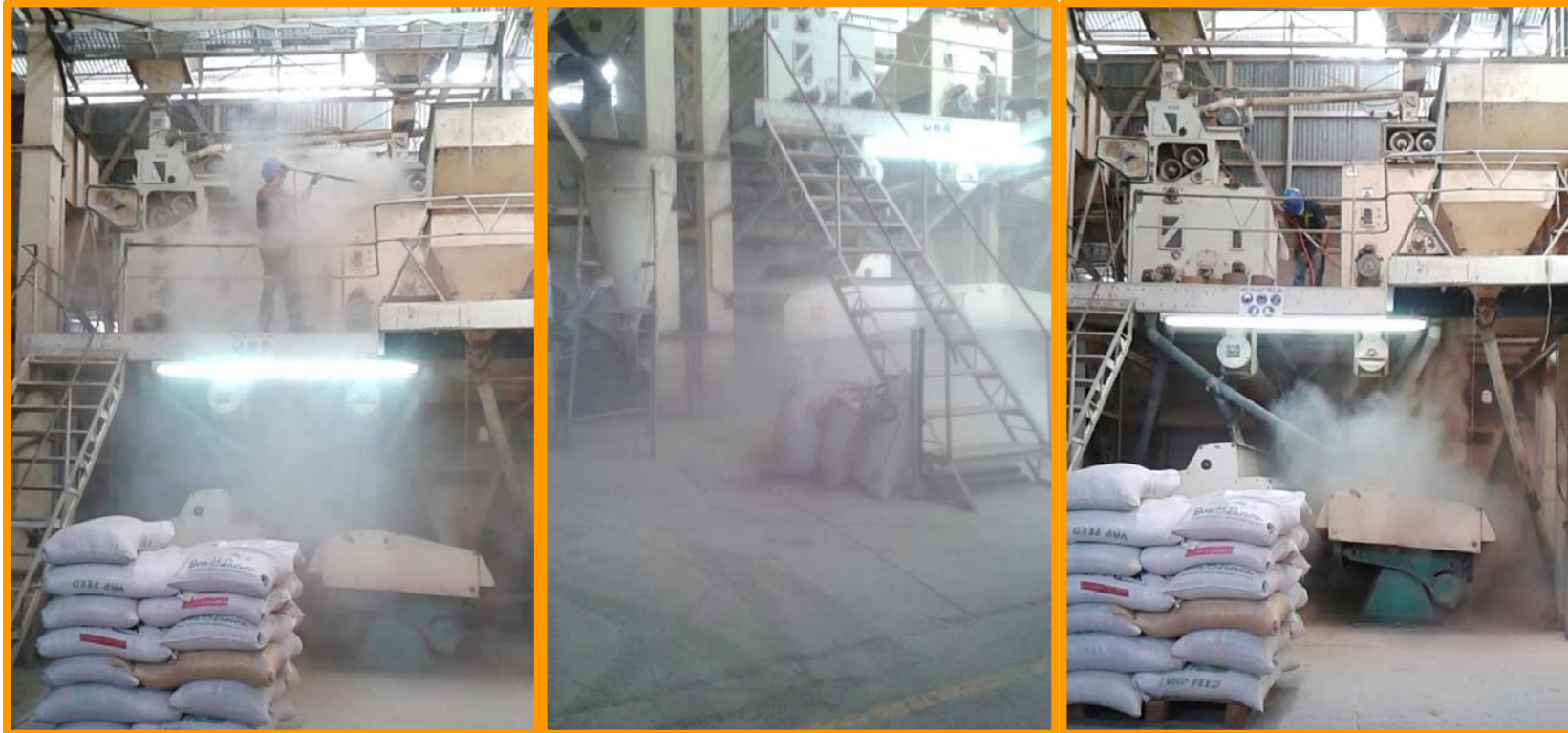
Limpieza de área de pilado con aire comprimido
